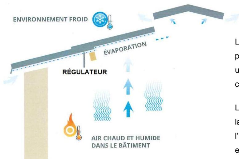
Le **Régulateur de condensation** est un produit industriel textile non-tissé contenant un liant chimique aux composants spéciaux créant une surface très poreuse.
